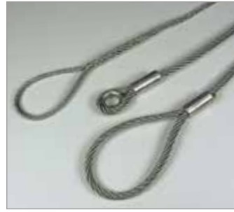
Anschlagseile - nach EN 13414-1 gespleißt und verpresst bis 34 mm Ø in verschiedenen Ausführung lieferbar.
