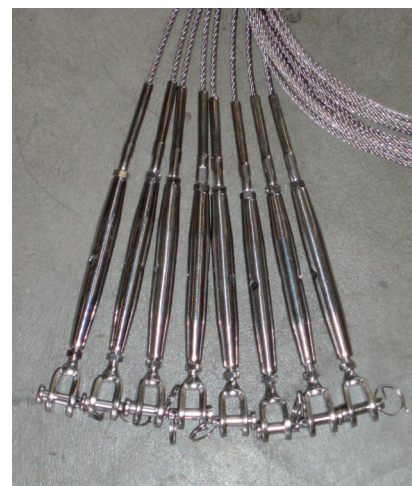
Maschinelle Verpressung von ASS Terminals
