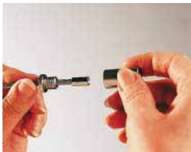
Montage mittels verpresstem ASS - Zylinderterminal
