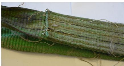
Beschädigung von tragenden Nähten
