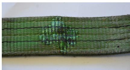
Beschädigung durch Überhitzung, Verschmelzung - glänzendes Aussehen
