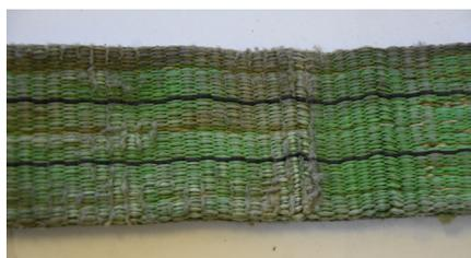
Beschädigung durch Abrieb, Schnitte
