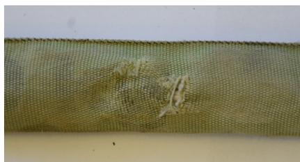
Beschädigung der Hülle durch Abrieb, Schnitte
