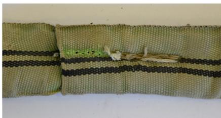
Beschädigte Nähte der Ummantlung
