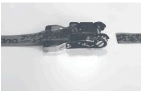
Bild6 // Verbinden der Ratsche mit der SMA-Slackline, Ausgangsposition
