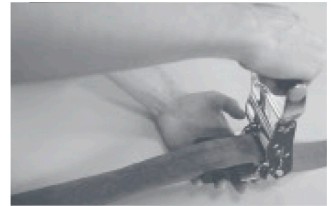
Bild11 // Spannen der Ratsche
