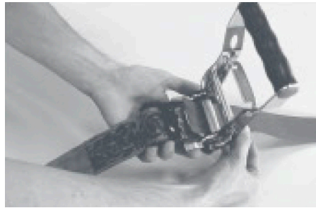
Bild9 // Bandeinführung in die Wickelwelle
