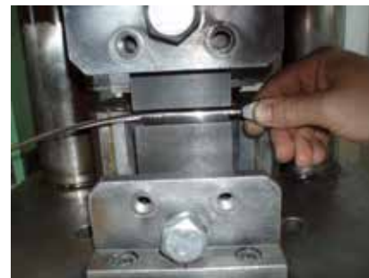
Maschinelle Verpressung von ASS Terminals
