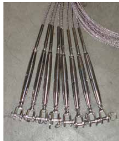
Maschinelle Verpressung von ASS Terminals
